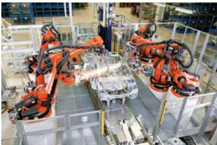
**Le système Kuka assiste les ouvriers dans le domaine de la soudure. Cette nouvelle génération de robots industriels travaille désormais côte à côte avec les employés d'usine.**
